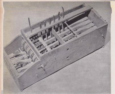
La Macaroni Box di Dorr E. Felt (1885) fu la prima macchina a tastiera e a ordine multiplo in grado di funzionare. In questo modello rudimentale (ispirato a Felt dall'osservazione del movimento interno di una piallatrice) i tasti sono costituiti da stecchini, i guida-tasti da forcelle meccaniche e le molle da una serie di elastici.
