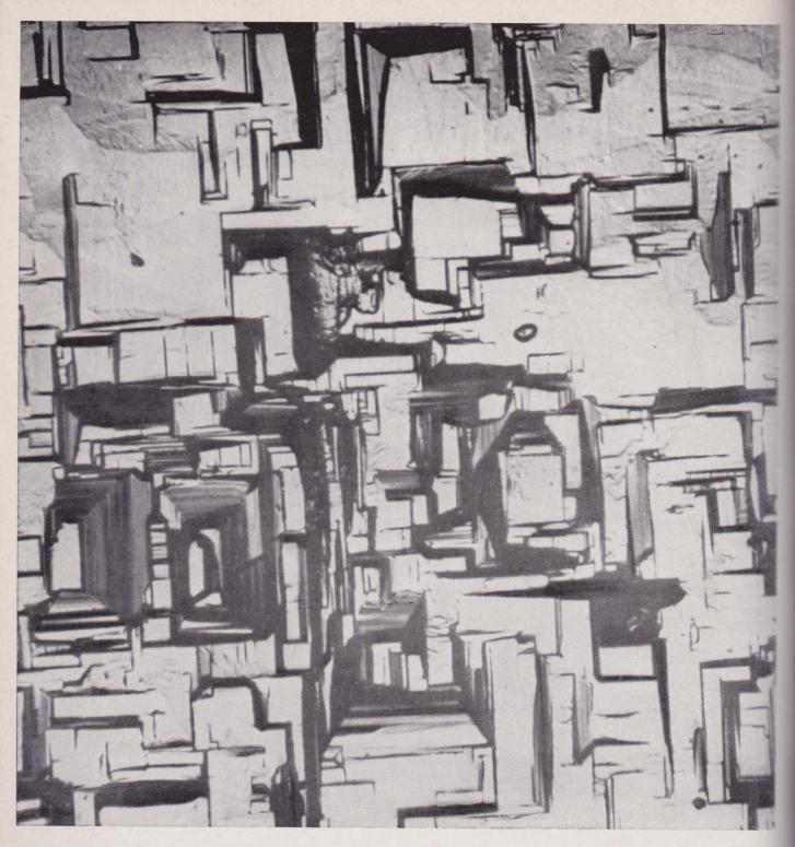
Cristalli formatisi in seguito al processo di vaporizzazione su un substrato di silicato (IBM).
