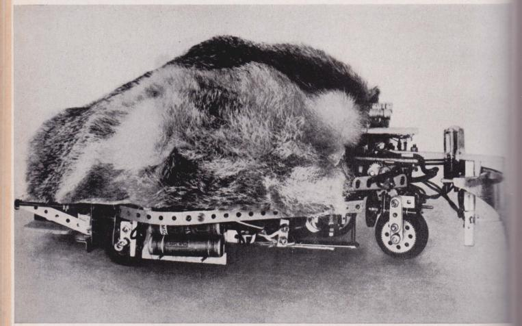
La Volpe cibernetica di Albert Ducrocq « si muove in modo autonomo, perché la ruota anteriore — direttrice e motrice — si trova proprio sotto al collo, mentre la sua testa ha un campo di esplorazione di 180° ».
