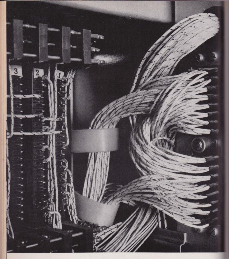
Un particolare dell'elaboratore Elea classe 9000. Collegamento dei pacchi di piastrine con i «connettori» verso l'esterno (Olivetti).
